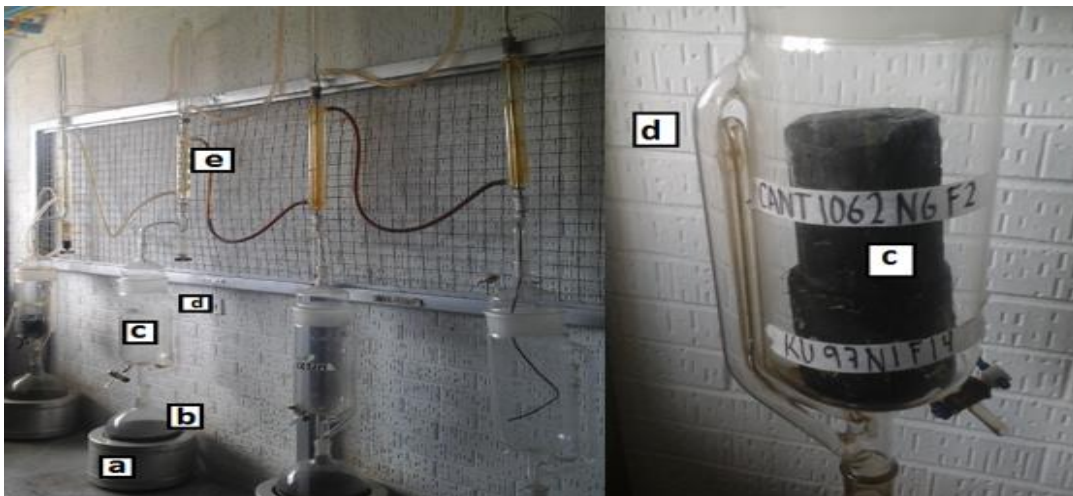
Figura 3 Sistema de destilación cíclica de disolventes para extracción de fluidos
