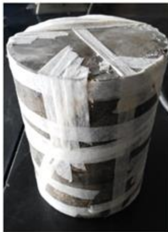
Figura 32 Muestra de diámetro completo con relleno.
